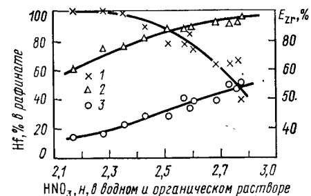
Рис. 237. Влияние общей кислотности на экстракцию и разделение циркония и гафния в сплошной органической фазе при использовании пластин из тефлона с отверстиями диаметром 7,9 мм: 1 — содержание гафния в рафинате, 2 — содержание циркония в органическом растворе, 3 — содержание свободной кислоты в рафинате
