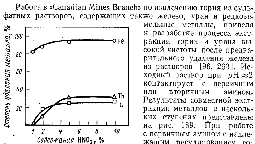
Рис. 96. Одноступенчатая промывка насыщенного Primene азотной кислотой. Концентрации: урана 1,41 г/л, тория 0,62 г/л, железа 0,42 г/л
